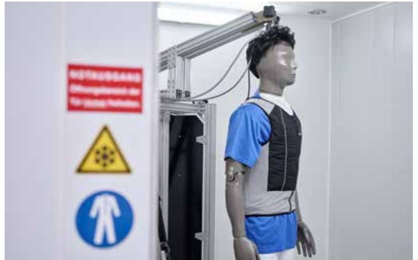
Jede Kühlweste wurde in der Klimakammer an der thermischen Puppe auf ihre Kühlleistung über und unter der Arbeitskleidung geprüft.
