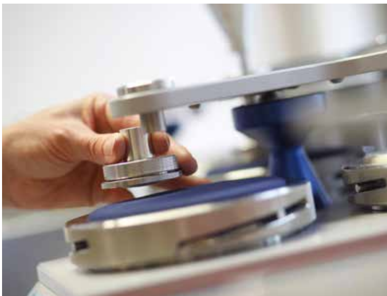
Scheuerprüfung: Wie unempfindlich verhält sich der Westenstoff gegen Abrieb und Verschleiß?
